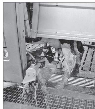
Roboten tvättar spenarna innan den siktar in sig och placerar sugkopparna rätt på respektive spene. Det går på några sekunder.
